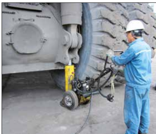
◀ Enerpac POW'R-RISER® utilizzato per operazioni minerarie per sollevare attrezzature pesanti.
